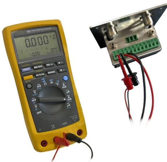
Raccordement de la sortie courant 0/4-20 mA :
