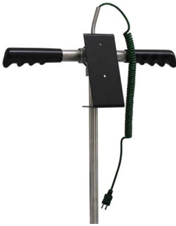
Sonde compost avec support type KSP
