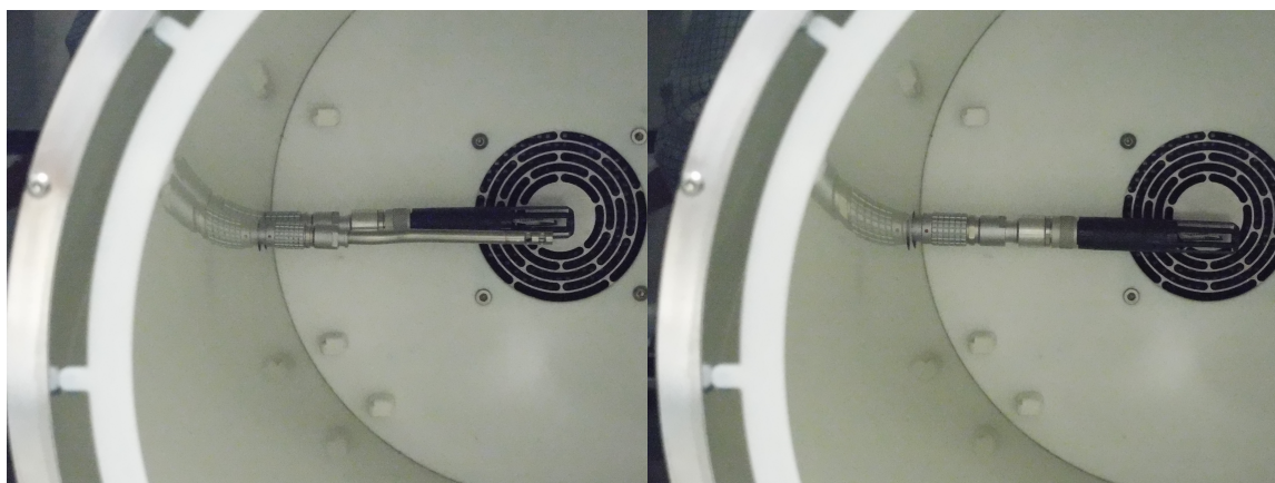
Figure : Capteur de contrôle HC2 et élément sensible PT100 de l'HG2-XL, sur la photo de droite, l'élément sensible est déjà retiré
