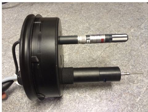
Figure 22 : Capteur monté sur la face intérieure de la porte
