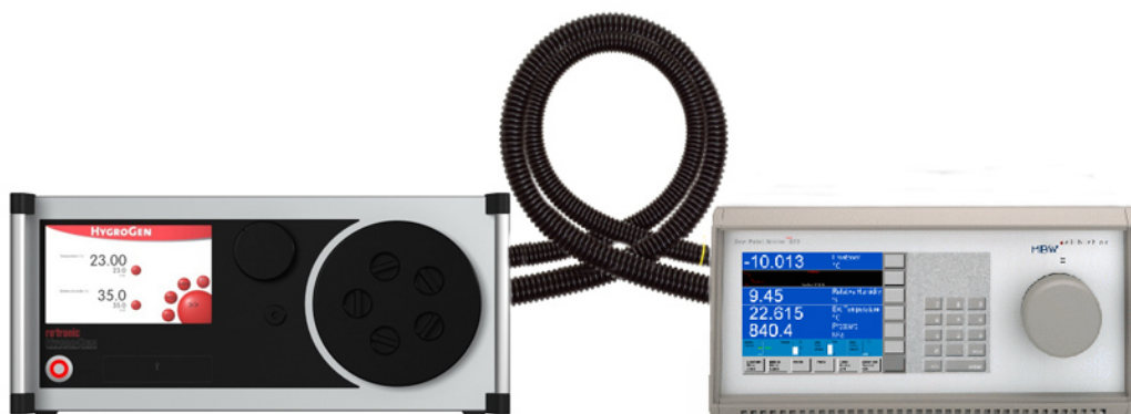
Figure : HygroGen2/Miroir à point de rosée avec conduits d'échantillonnage chauffés
