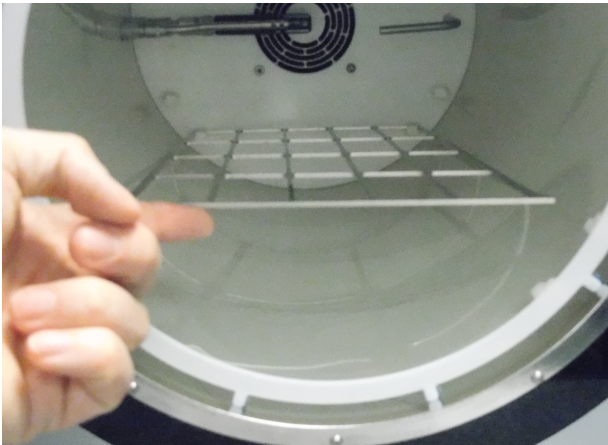
Figure : système de grilles de support de l'HygroGen2-XL
