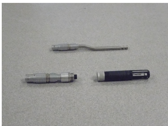
Figure : Élément sensible PT100 et capteur de contrôle HC2 déconnectés du boîtier Lemo
