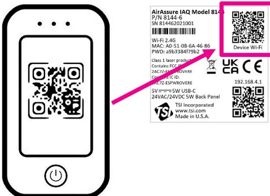
8. Si vous n'êtes pas connecté automatiquement, vous pouvez toujours vous connecter manuellement en recherchant le réseau Wi-Fi® et la connexion à celui répertorié comme « AirAssure IAQ 8144XXX... »
