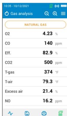
La sonde peut être insérée dans le conduit. L'analyseur affiche les mesures.
