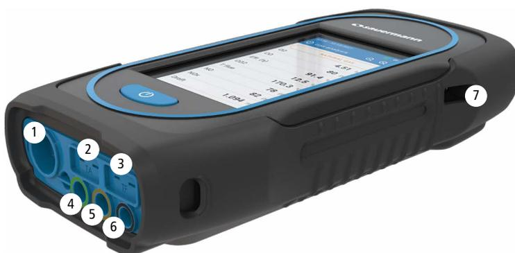
1. Connexion Min-DIN en option pour les sondes air ambiant CO et CO<sub>2</sub>
