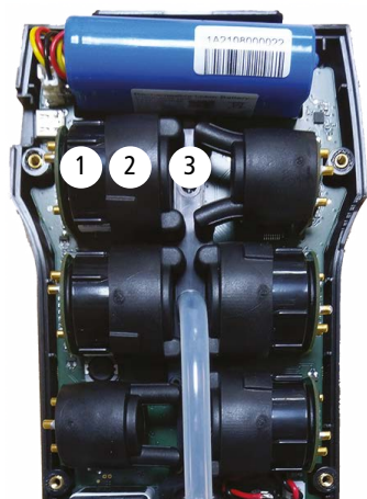
Emplacement des cellules
