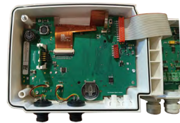
Le module de communication sans fil est correctement insérée.
