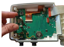
Segurar o módulo de comunicação sem fios entre os dedos, como indicado na imagem, e fazê-lo deslizar entre os dois suportes.
