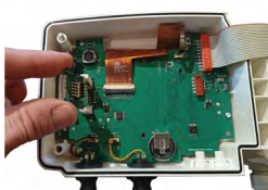
Halten Sie das drahtlose Kommunikationsmodul zwischen Ihren Fingern, wie in der Abbildung gezeigt, und schieben Sie es zwischen die beiden Halterungen.
