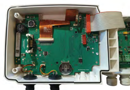
Das drahtlose Kommunikationsmodul wird direkt eingesetzt.
