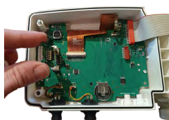
Sujete el módulo de comunicación inalámbrica con los dedos tal como se indica en la imagen y deslicelo entre los dos soportes.
