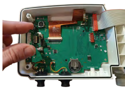
如图, 将无线通讯模块 插入到支架中
