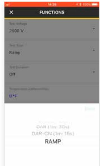
Le contrôle à distance de votre testeur d'isolement vous permet d'utiliser votre smartphone pour configurer un test de rampe se terminant à 2 500 V. Ces paramètres peuvent être saisis à partir d'une distance de sécurité de l'unité sous test et de tout autre équipement potentiellement dangereux.
