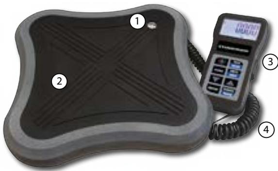
1. L'indicateur de niveau de la plate-forme permet de s'assurer que l'unité est placée sur une surface plane.
