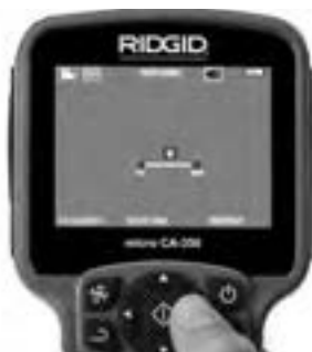
Figura 14 – Ajuste de los LED
