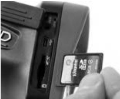
Figura 9 – Introducción de la tarjeta SD
