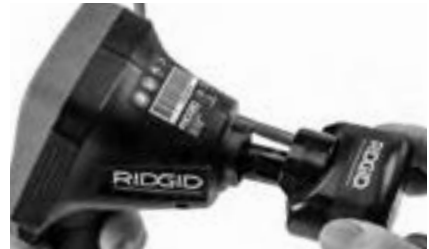
Abbildung 18 - Mit eingebautem Kameraanschlussstecker
