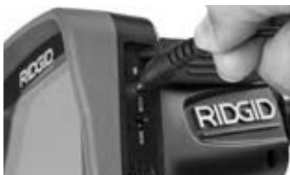
Figura 6 – Alimentación del aparato con el adaptador CA
