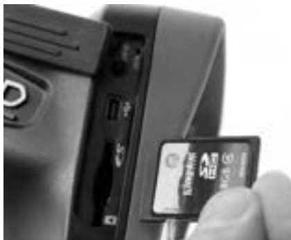
Abbildung 9 - Einsetzen der SD-Karte
