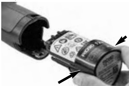
Figura 5 – Extracción e instalación de la batería
